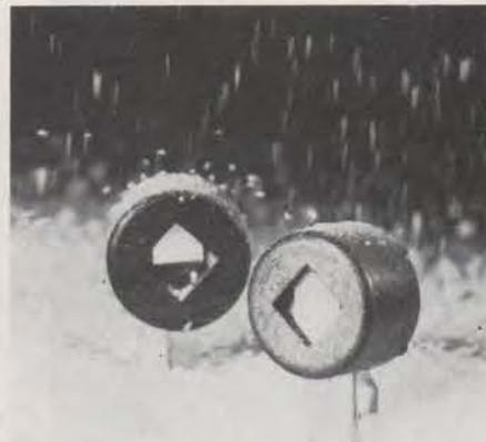
Mais pour que la démagnétisation ne provoque pas, elle-même, de nouveaux parasites, il faut que l'influence du champ généré soit rapidement neutralisée. Les thermistances sont traversées par un flux de courant de travail et échauffées, le blocage du courant augmentant avec l'accroissement de la température.
