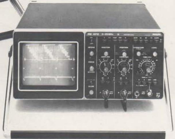
Le **PM 3214** - 25 MHz/2 mV : **Retard variable étalonné** et toutes possibilités de balayage grâce à une base de temps principale et à une base de temps retardée à déclenchement indépendant.
