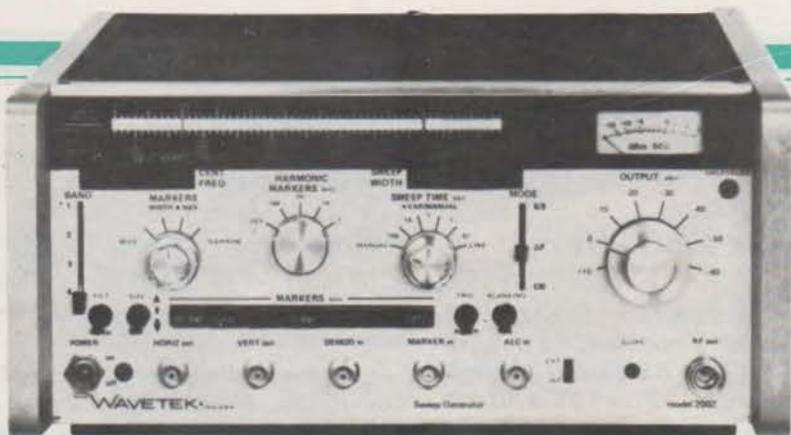
Le niveau de sortie est de +13 dBm (20 milliwatts) nivelé à mieux que  $\pm 0,5$  dB dans toute la gamme de fréquence. Un atténuateur étalonné par bond de 10 dB plus vernier continu donne une dynamique de +13 dBm à -77 dBm.
